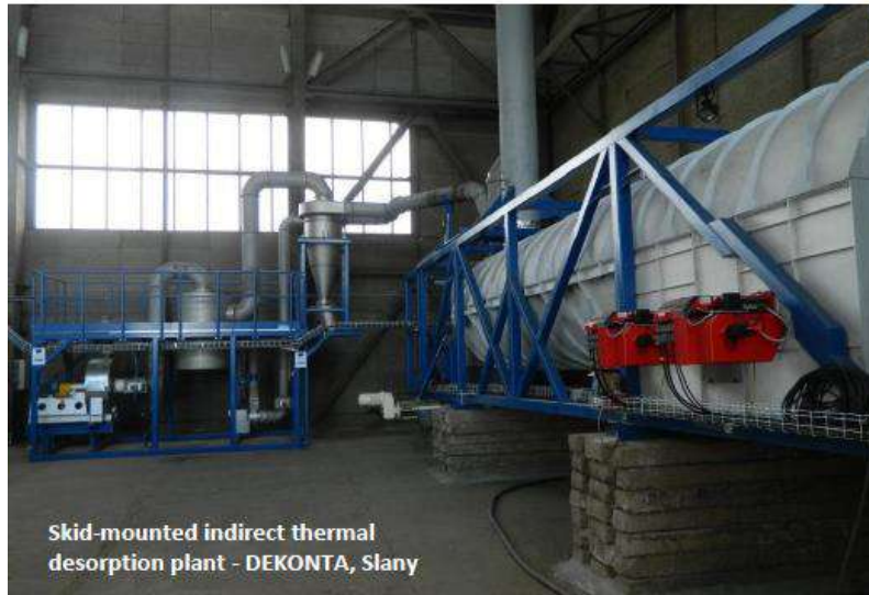
איור 18 : מתקן TD נייד בחימום עקיף של חברת Dekonta
